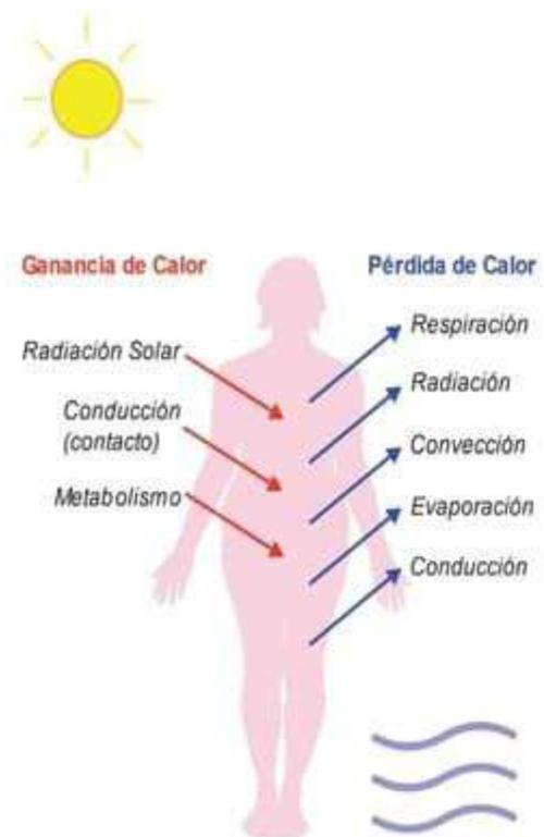
**Fig. 8-P3.** Diagrama de flujo de energía en el cuerpo humano.
