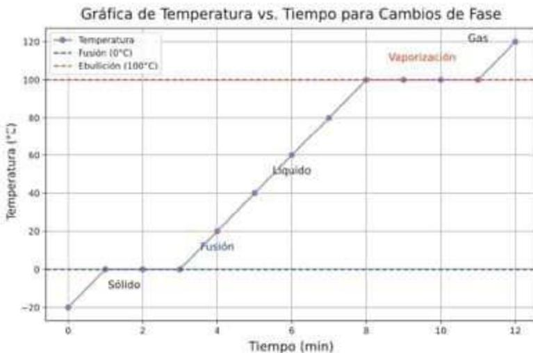
**Fig. 4-P13.** Gráfica de temperatura-tiempo para el agua, ilustrando los cambios de fase de sólido a líquido y de líquido a gas.
