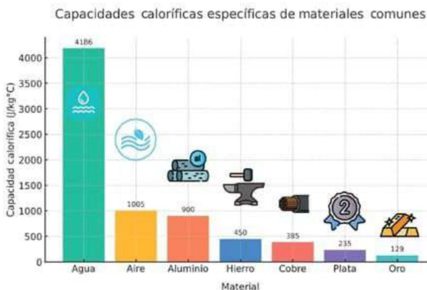
**Fig. 7-P2.** Capacidades caloríficas específicas de materiales comunes, mostrando la cantidad de energía necesaria para cambiar la temperatura de cada material.
