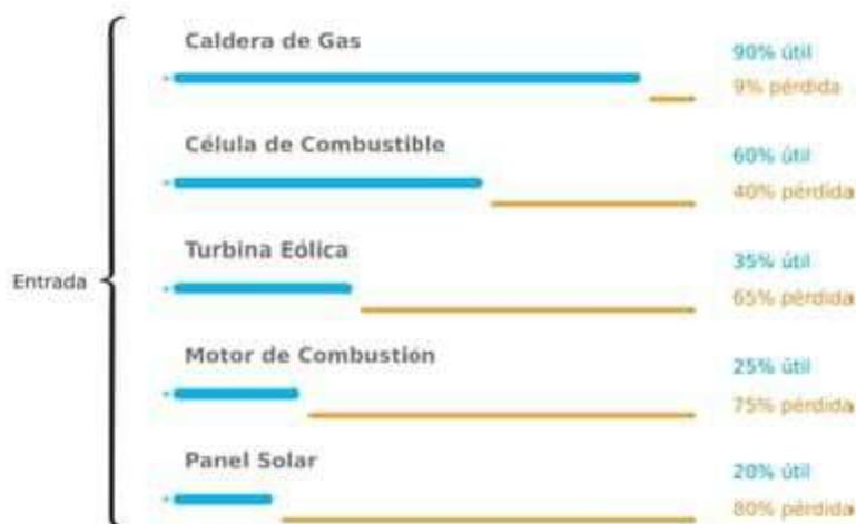
Fig. 7-P4. Eficiencia energética de diversos dispositivos y procesos de conversión de energía. La eficiencia se expresa como el porcentaje de energía de entrada que se convierte en energía útil.
